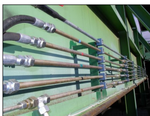
Hlavní větve vedené k pěti odpojitelným okruhům mazaných míst
