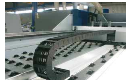
chainflex® CF130.UL pro dřevoobrábění v energetickém řetězu systém E4/light.
